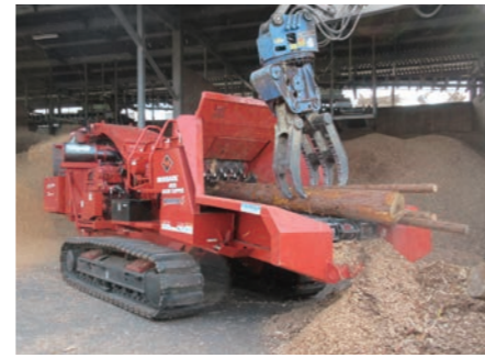
木材破砕機への投入
