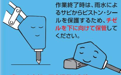
作業終了時は、雨水によるサビからピストン・シールを保護するため、**チゼルを下に向けて保管**してください。
