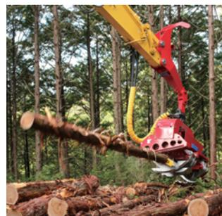
狭い作業道でも、作業現場に応えるプロセッサ
