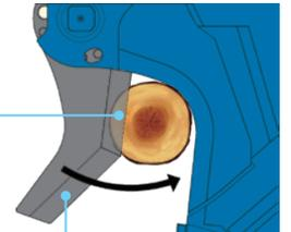
複合ストレート形状により、大口径の導入部を実現。小径木のまとも切りに威力を発揮
